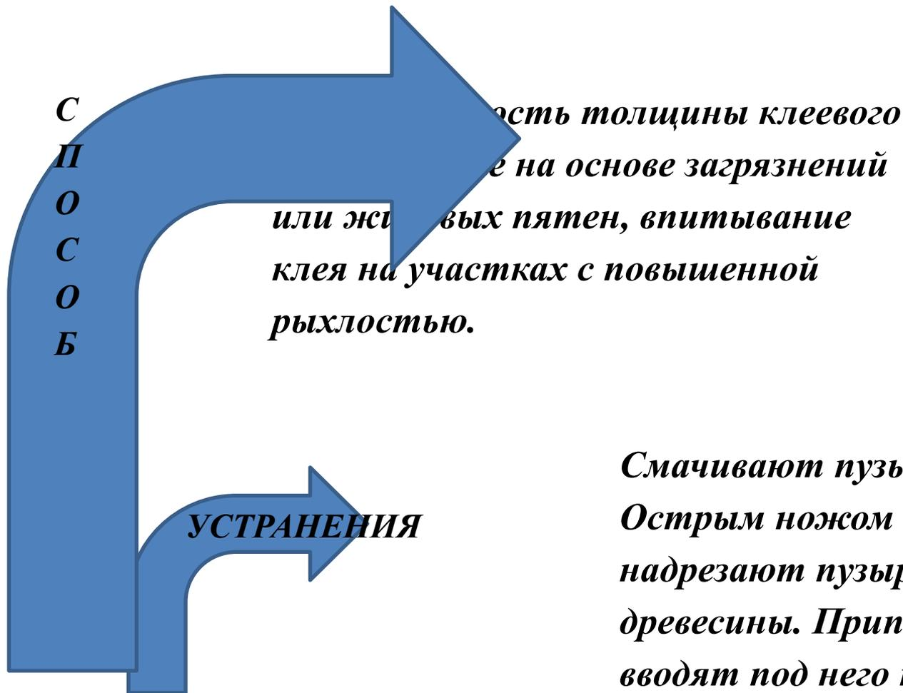
*Слишком большая толщина клеевого слоя, нанесенного на основе загрязнений или жирных пятен, впитывание клея на участках с повышенной рыхлостью.*
