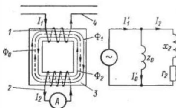
Как видно из схемы, основными элементами ТТ, участвующими в преобразовании тока, являются первичная обмотка 1 и вторичная обмотка 2, намотанные на один и тот же магнитопровод 3. Первичная обмотка включается последовательно (в рассечку токопровода высокого напряжения 4), т.е. обтекается током линии  $I_1$ . Ко вторичной обмотке подключаются измерительные приборы или реле. При работе трансформатора тока вторичная обмотка всегда замкнута на нагрузку.
