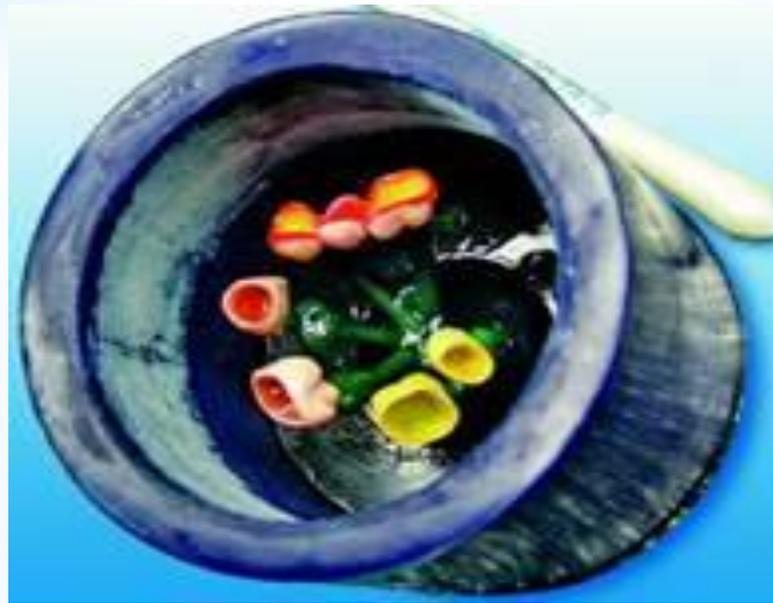
Работа с формовочными, или паковочными, согласно принятой терминологии, материалами на основе фосфатных связующих для литья кобальт- и никельхромовых сплавов, а так же паковочными массами для литья благородных сплавов, для получения стабильных качественных результатов при отливке деталей зубных протезов требует обязательного соблюдения рекомендаций инструкции по применению и хранению этих материалов, а так же некоторых правил и приёмов в работе.
