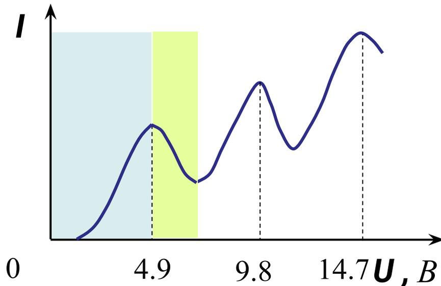
При значениях  $U$ , кратных  $4.9$  В электроны могут несколько раз испытывать неупругие столкновения, отдавая каждый раз по  $4.9$  В атому ртути.
