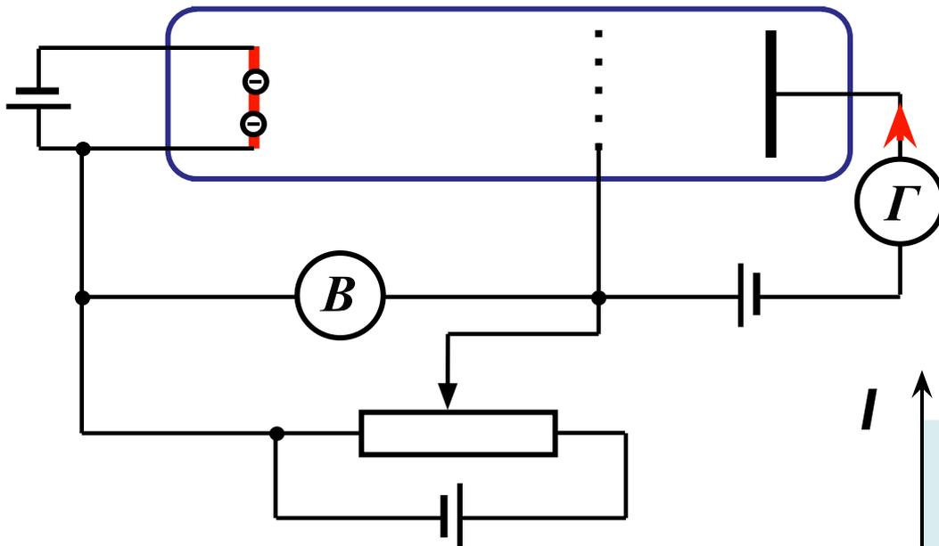
При  $U \geq 4.9$  В кинетическая энергия электронов  $W_k \geq 4.9$  эВ, столкновения электронов с атомами ртути с большой вероятностью становятся неупругими.
