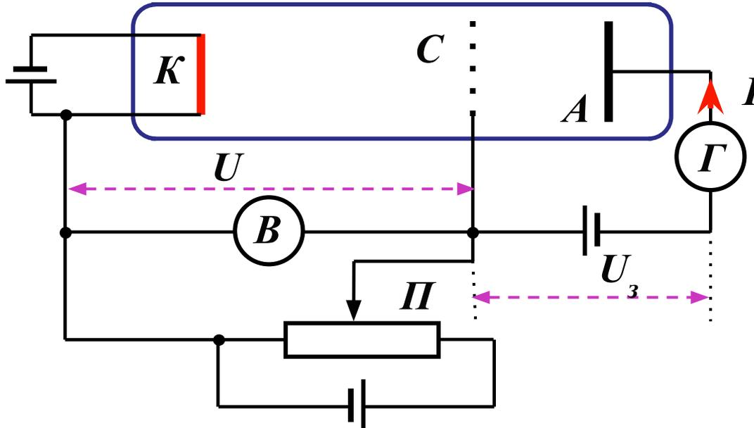
*K* - катод*A* - анод*C* - сетка*П* - потенциометр*V* - вольтметр*Г* - гальванометр
