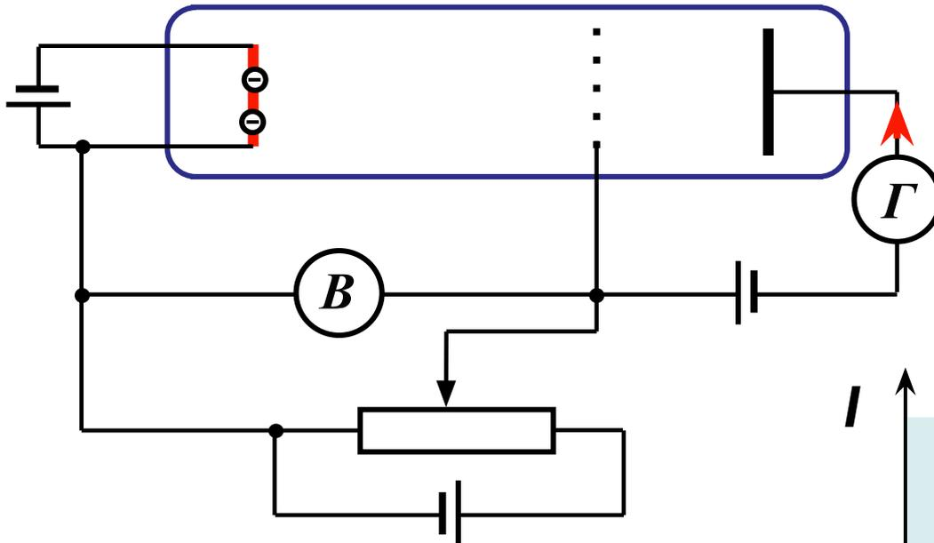
При  $U < 4.9$  В кинетическая энергия электронов  $W_k < 4.9$  эВ, столкновения электронов с атомами ртути упругие. Ток плавно нарастает.
