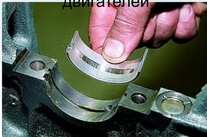
Вкладыши подшипников в двигателях тепловозов
