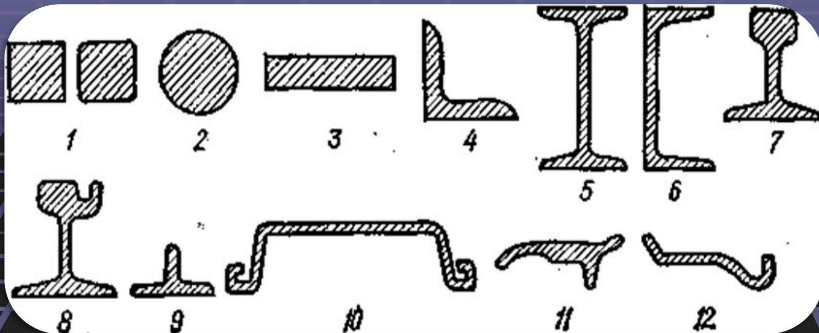
**Виды сортового проката общего назначения:** 1 — квадратный; 2 — круглый; 3 — полосовой; 4 — угловой; 5 — двутавровый; 6 — швеллерный; 9 — тавровый и некоторые виды сортового проката специального назначения — 7 и 8 — рельсовый; 10 — шпунтовый; 11 — полоса для башмаков гусениц тракторов; 12 — полоса для ободьев колес автомобилей.
