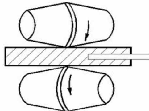
Методом поперечной прокатки получают, например, зубчатые колеса и звездочки цепных передач на специальных станках с зубчатыми валками.
