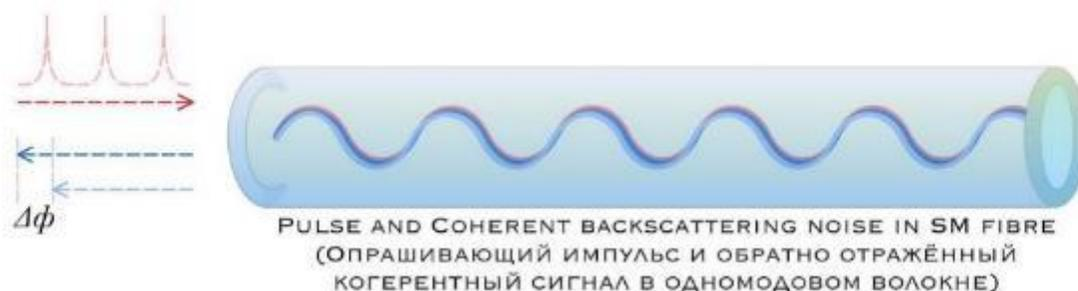
Распределённые вибро-акустические системы используют оптическую схему с импульсным и узкополосным лазером (обеспечивает когерентность), для обеспечения когерентности сигнала на больших расстояниях.
