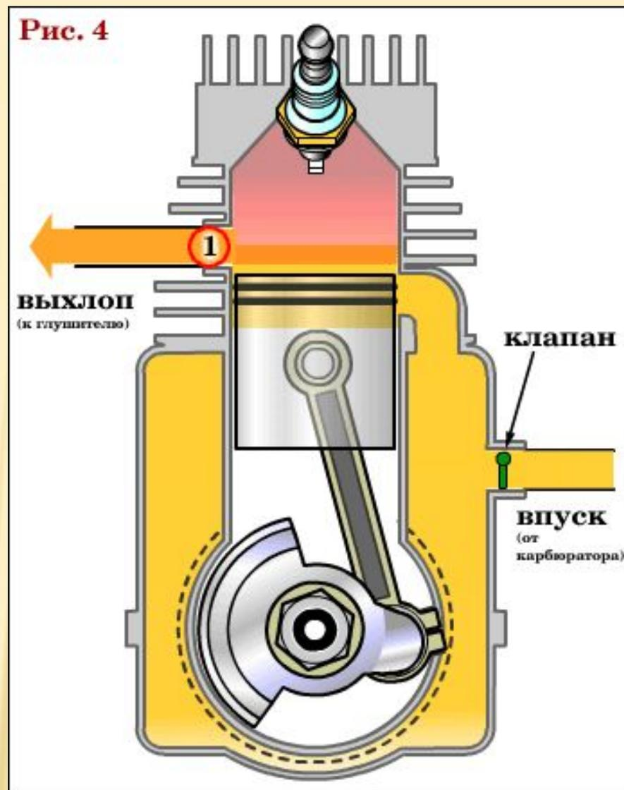
При дальнейшем перемещении поршень открывает продувочное окно (1) и сжатая в кривошипной камере горючая смесь поступает по каналу (2), заполняя цилиндр и осуществляя продувку его от остатков отработавших газов.
