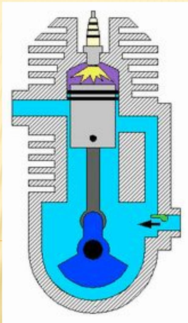
**В отличие от 4-х тактного двигателя в 2-х тактном двигателе все процессы, составляющие рабочий цикл (наполнение, сжатие, сгорание, расширение и выпуск) происходят за 2 такта, т.е. когда поршень совершает движение от ВМТ к НМТ и от НМТ к ВМТ, - всего за 1 оборот коленчатого вала ( $360^\circ$  его поворота).**
