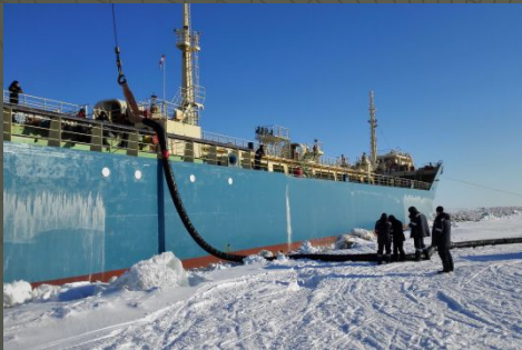
Подготовка танкера к погрузке нефтью зимой по шланголинии
