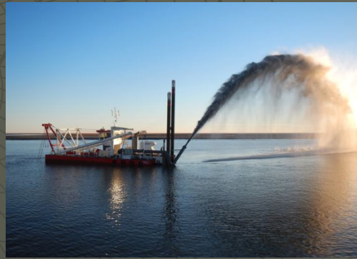
Дноуглубление на подходном канале фрезерным рыхлителем атакующего типа
