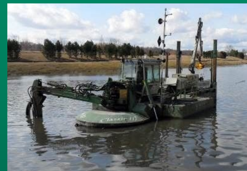
Миниземснаряд типа Ватермастер, ковш, фреза, забивка свай
