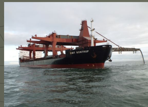
Выгрузка щебня по схеме балкер-подводный карьер
