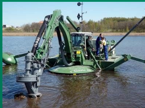
Миниземснаряд типа Ватермастер, ковш, фреза, забивка свай
