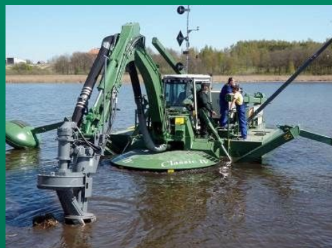
Миниземснаряд типа Ватермастер, ковш, фреза, забивка свай
