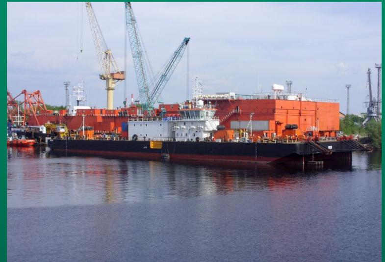
Многофункциональная баржа типа «Гефест» является технологической баржей с 8-ми точечной системой позиционирования, штатным бункером для засыпки щебня. На барже установлен кран, система гидроразмыва грунта, водолазная станция.
