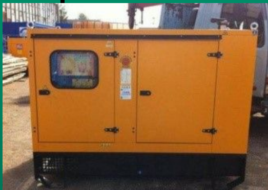
Дизель генератор в контейнере
