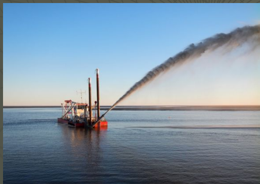
Дноуглубление на подходном канале фрезерным рыхлителем атакующего типа
