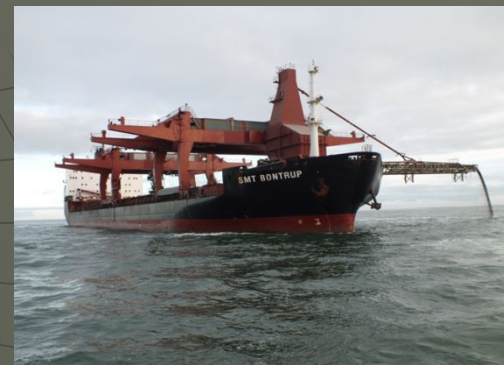
Выгрузка щебня по схеме балкер-подводный карьер
