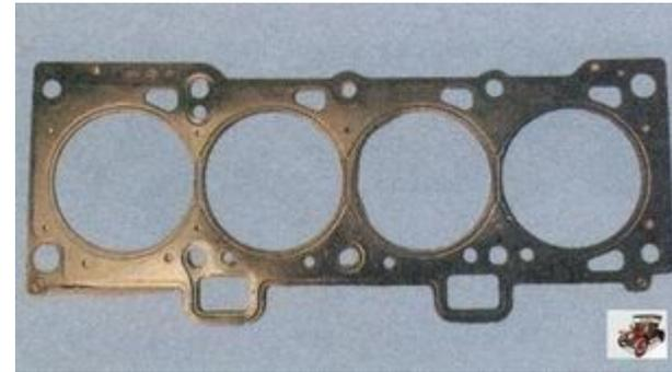
*Прокладка головки блока цилиндров — однократного использования, поэтому при каждом снятии головки блока прокладку необходимо заменять.*
