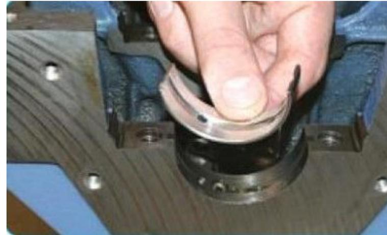
Если не предполагается замена вкладышей, при снятии промаркируйте на нерабочей стороне вкладыши относительно крышек и постелей.
