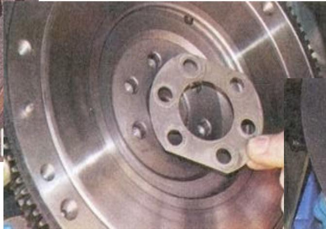
Снимите маховик с фланца коленчатого вала.
