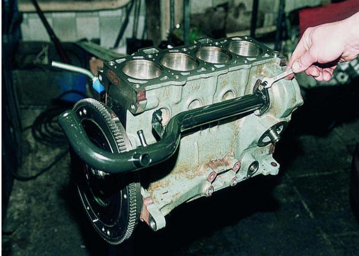
Снимите трубу с уплотнительной прокладкой.
