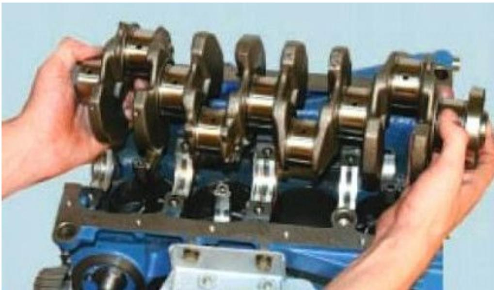
Снимите упорные полукольца, установленные в проточки средней опоры коленчатого вала
