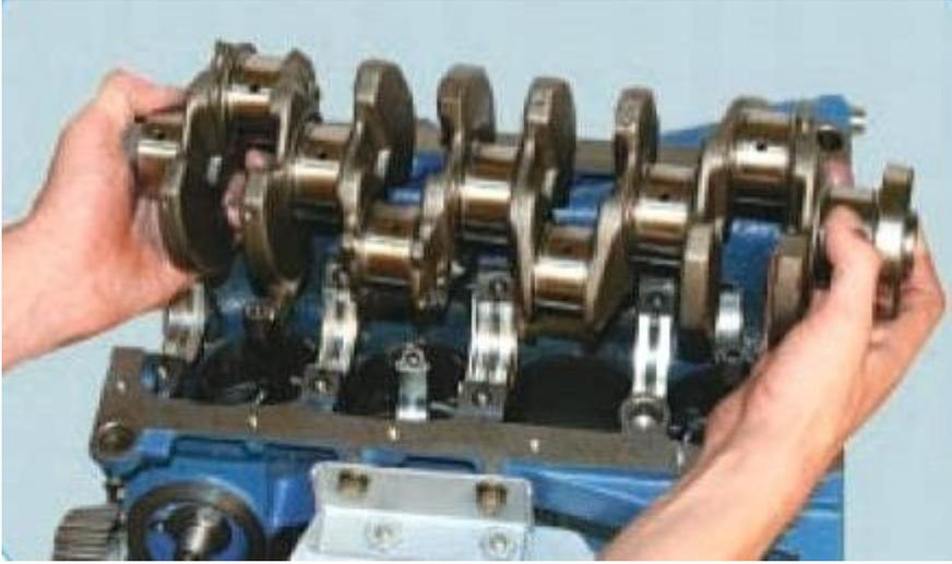
Смажьте упорные полукольца моторным маслом. Обратите внимание на канавки полуколец: этими сторонами полукольца должны быть установлены к щекам коленчатого вала.
