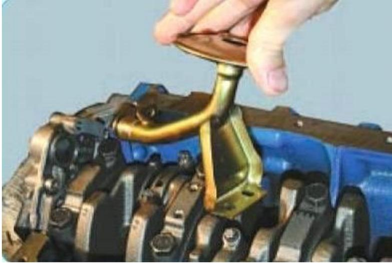
Обратите внимание: в проточке патрубка приемника установлено резиновое уплотнительное кольцо. Сильно обжатое, затвердевшее или надорванное кольцо обязательно нужно заменить.
