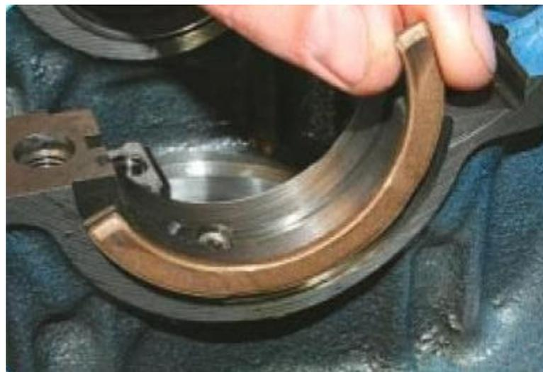
Выньте вкладыши из крышек коренных подшипников...
