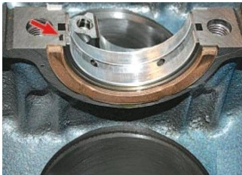
После установки вкладышей в постели их концы немного выступают наружу, поэтому для правильного ориентирования вкладышей при окончательной затяжке болтов крепления крышек подшипников проследите, чтобы выступание обоих концов было одинаковое.
