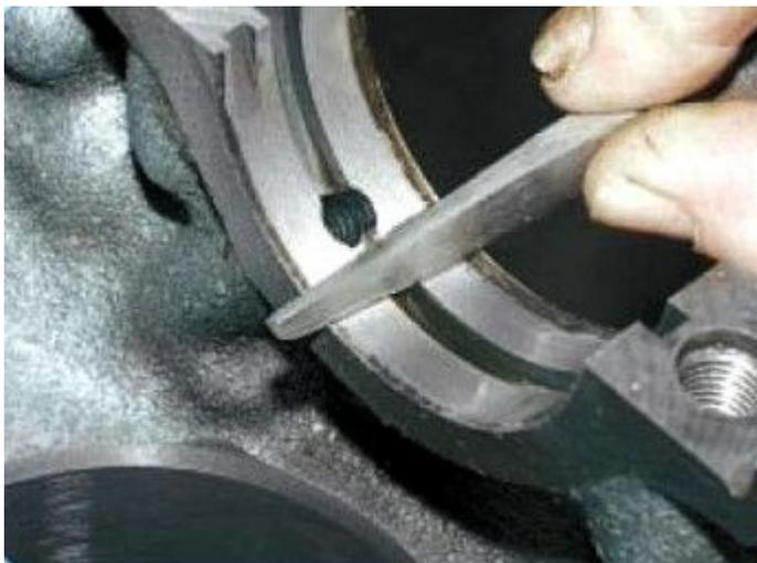
При установке вкладыши коренных подшипников в постели блока цилиндров в соответствии с метками, сделанными при разборке.
