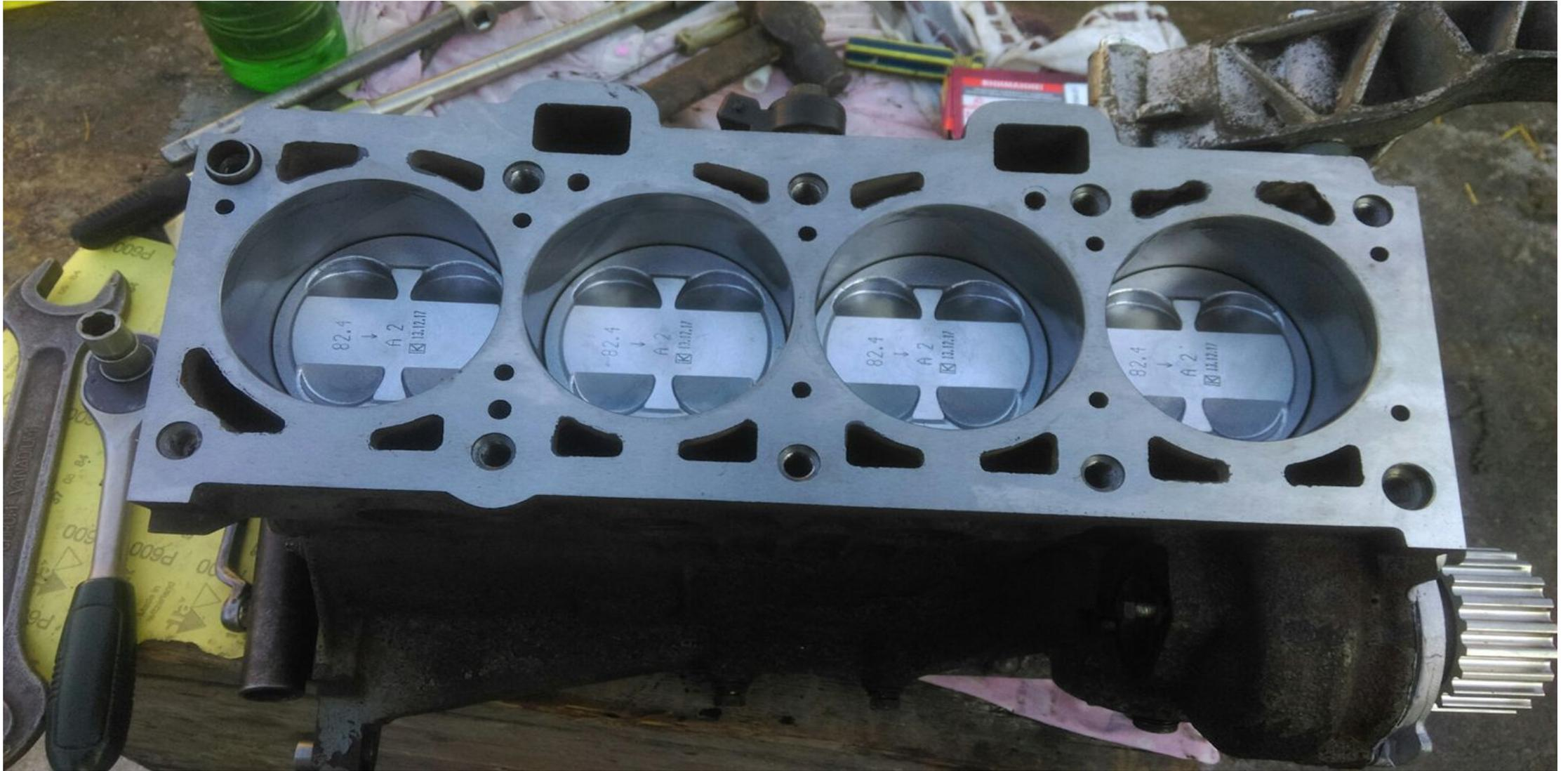
Поршни к автомобильным двигателям ВАЗ. Материал использованный при производстве – АК12М2МгН\*.
