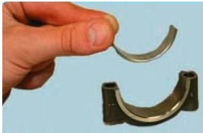
Если вкладыши остались на коленчатом валу, снимите их с вала
