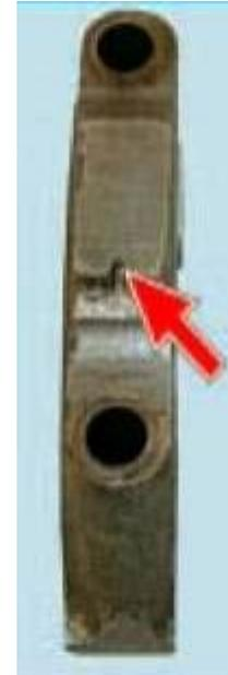
Если эти метки плохо видны, обязательно дополнительно промаркируйте крышки, чтобы установить их на прежние места: крышки **невзаимозаменяемые** (блок цилиндров обработан вместе с крышками).
