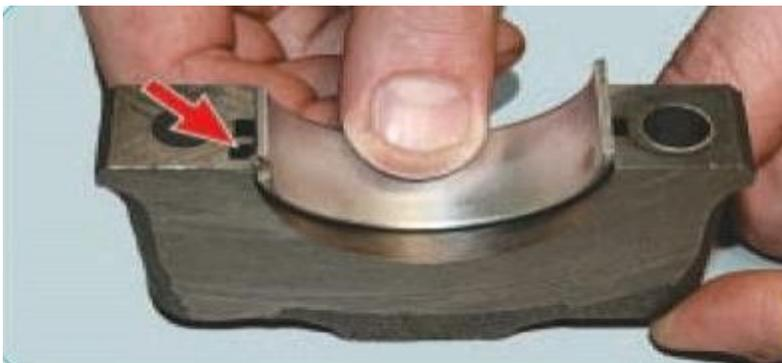
Установите крышки в соответствии с метками. На крышках нанесены метки (насечки) в соответствии с номером цилиндра. Исключение составляет пятая крышка, на которой нанесены две метки, как и на второй.
