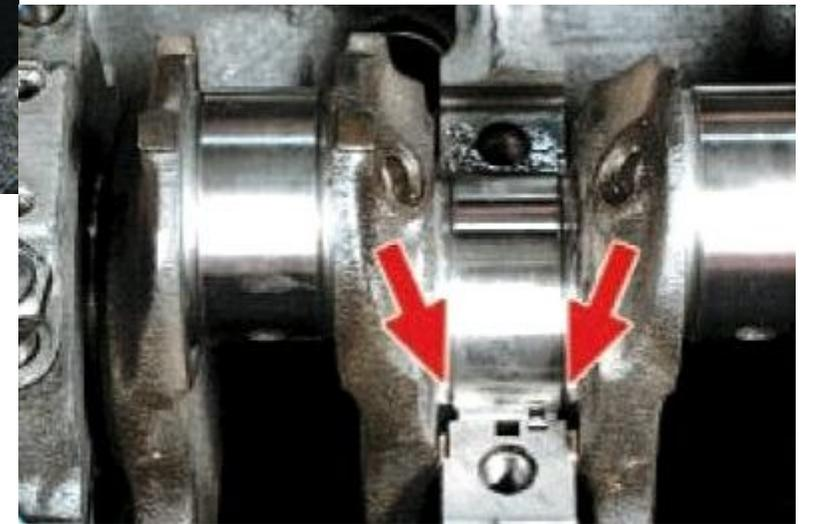
Вставьте вкладыши в крышки коренных подшипников в соответствии с метками, сделанными при разборке. При этом стопорные усики вкладышей должны войти в пазы крышек.
