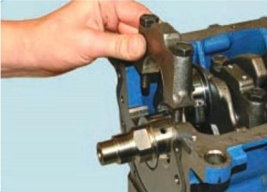
Крышки коренных подшипников промаркированы насечками в соответствии с номерами цилиндров.
