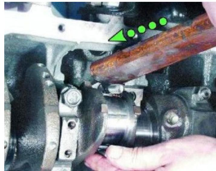
Номер цилиндра на крышке может быть не виден, в этом случае промаркируйте крышку номером цилиндра.
