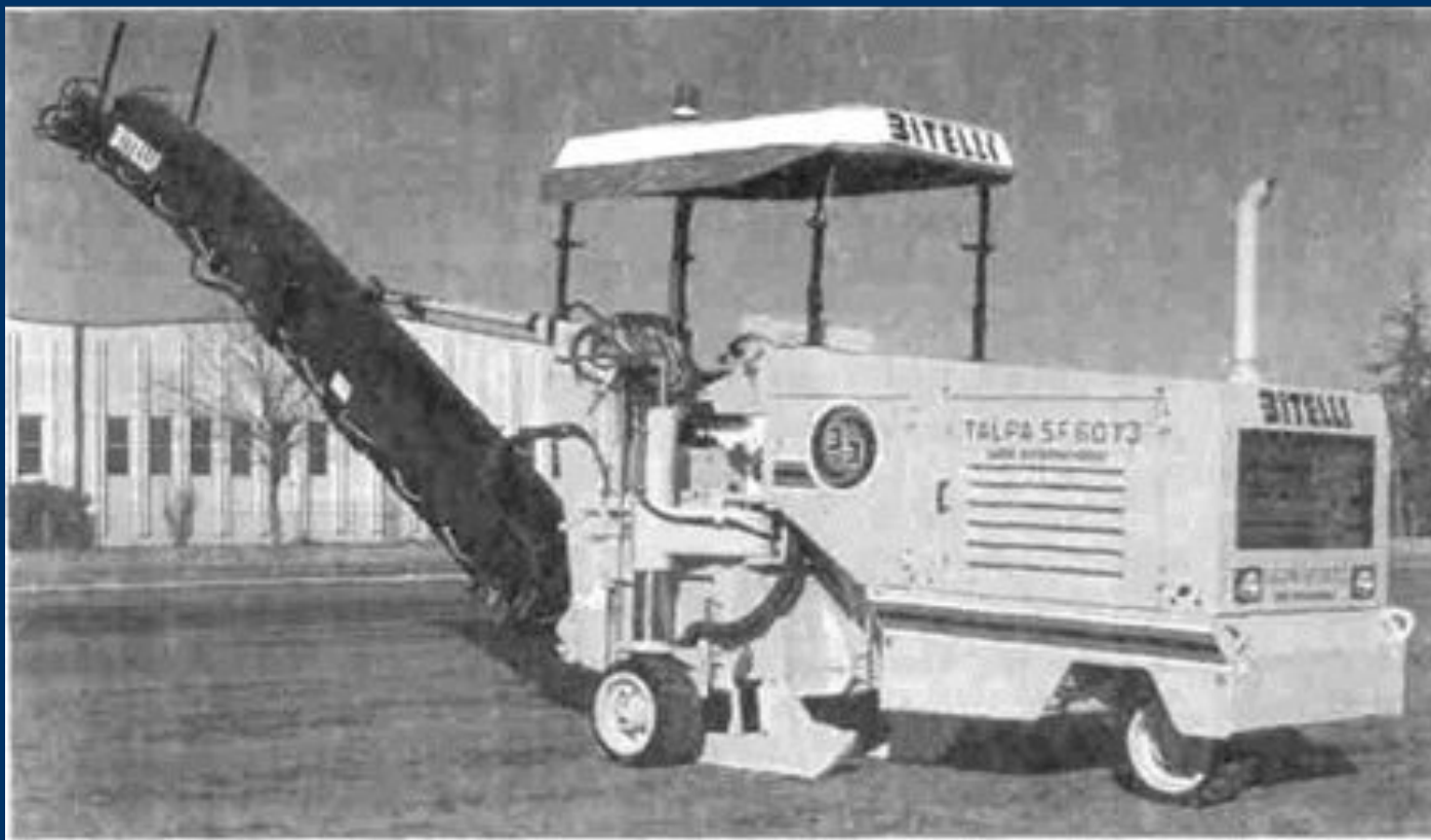
Самоходная фреза-планировщик на трехопорном колесном шасси с шириной фрезерования до 600 мм
