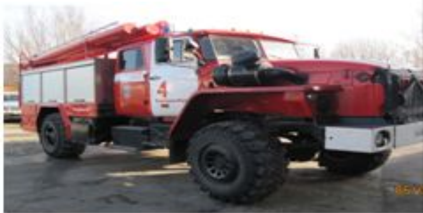
Пожарно-спасательный автомобиль ПСА-2,0-40/2(43206)
