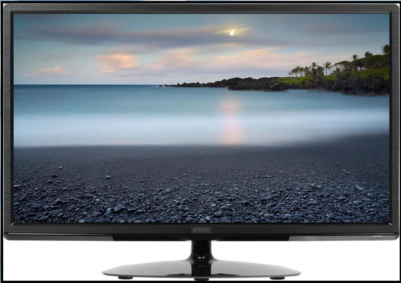
**Телевизор**— приёмник телевизионных сигналов изображения и звукового сопровождения, отображающий их на экране и с помощью громкоговорителей. Современный телевизор способен принимать телевизионные программы как с антенны, так и непосредственно от устройств их воспроизведения — например, видеомэгнитофона, DVD-проигрывателя или
