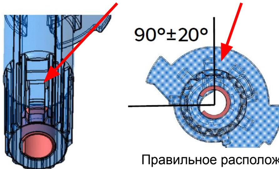
Правильное расположение предохранительной втулки
