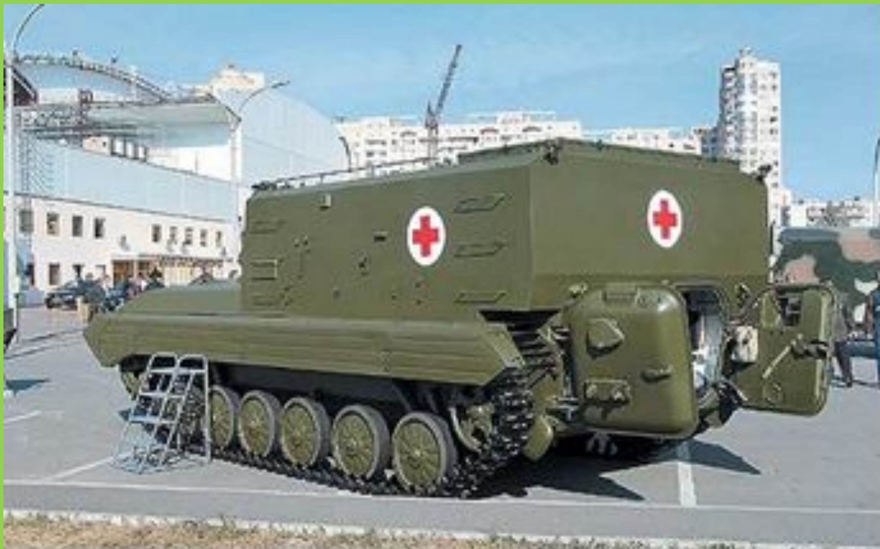
Рис. 3. Бронированная медицинская машина (БММ-1) на базе боевой машины пехоты БМП-1.
