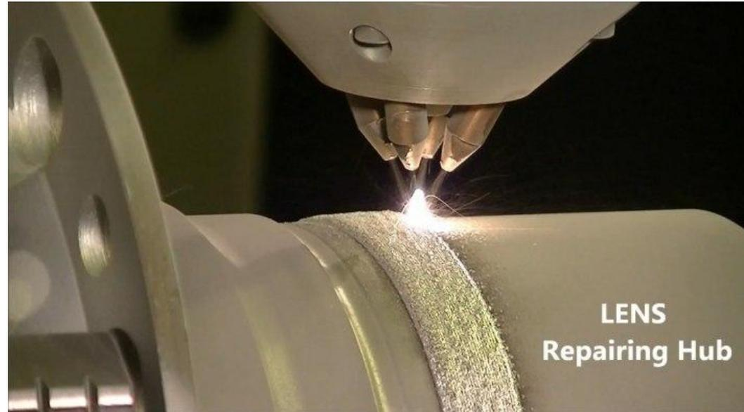
Материал в форме порошка выдувается из сопла и попадает на сфокусированный луч лазера. Часть порошка пролетает мимо, а та часть, которая попадает в фокус лазера мгновенно спекается и слой за слоем формируя трехмерную деталь.
