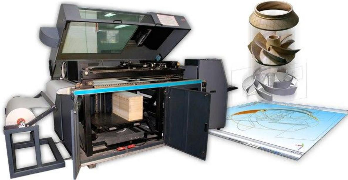
Тонкие ламинированные листы материала вырезаются с помощью ножа или лазера и затем спекаются или склеиваются в трехмерный объект.
