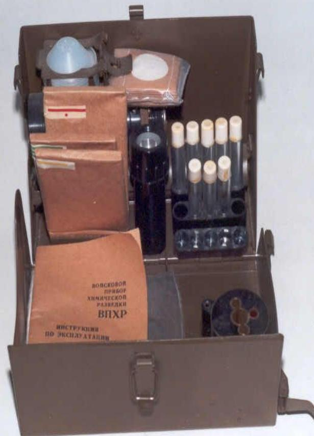
**Ручной насос** служит для прокачивания исследуемого воздуха через индикаторные трубки. На одном конце насоса имеется нож для надрезания трубок и отверстие (гнездо) для крепления индикаторной трубки. На втором конце ампуловскрывать для разбивания ампулы индикаторных трубок.
