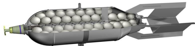
Зажигательная авиационная бомба с твердым горючим ЗАБ-50ТГ индекс 7-3-251 чертеж 3-0445 (1938г.)
