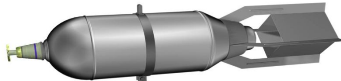
Зажигательная авиационная бомба с термитными шарами ЗАБ-100-65ТГ индекс 8-3-157 чертеж 3-01026 (1941г.)
