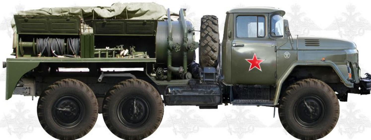
Авторазливочная станция АРС-14 на шасси автомобиля ЗИЛ-131.
