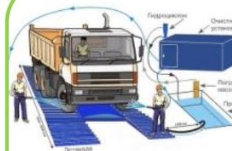
Пост мойки колес замкнутого цикла
