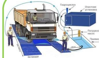
Пост мойки колес замкнутого цикла
