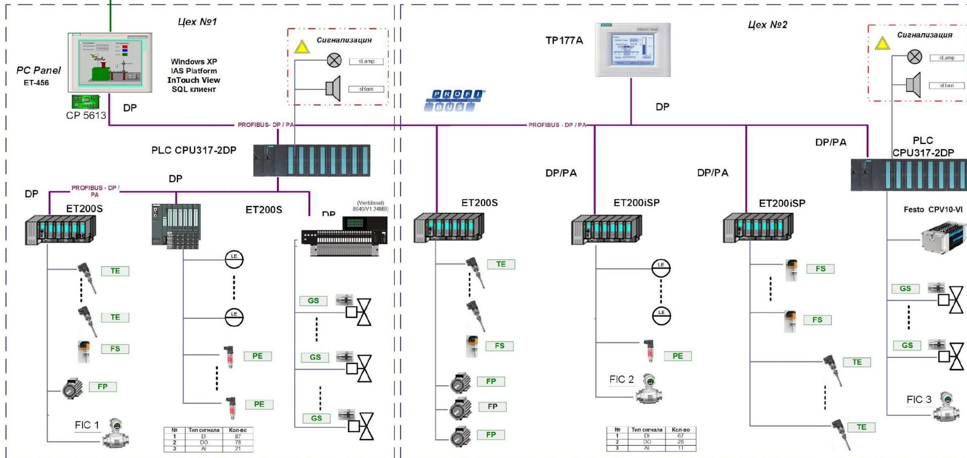
V - вентиль P - насос FS - датчик притока LH, LL, LM - дискретный датчик уровня DP - дозирующий насос LS - датчик уровня CV - регулируемый клапан PE - датчик давления QE - датчики электропроводности TE - датчики температуры FIC - датчики расхода
