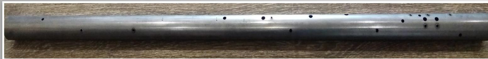
**Поперечина панели приборов с термосверлением 9833001. В окончательном исполнении устанавливается на автомобили Renault (Duster и Arkana)**
