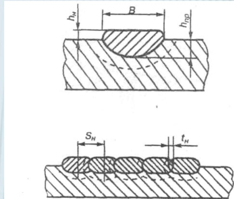
Рис. 44. Схема наплавки слоев:
