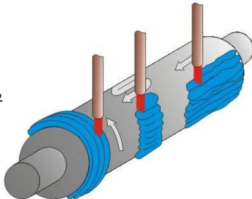
НАПЛАВКА ЦИЛИНДРИЧЕСКОЙ ПОВЕРХНОСТИ
