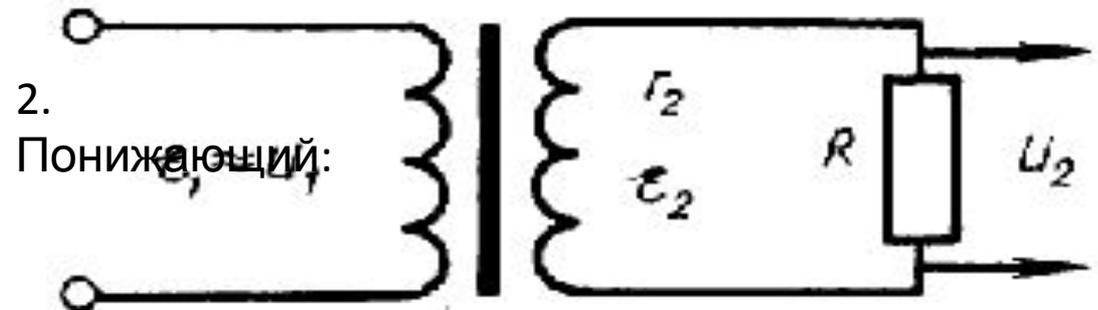
Схема трансформатора: слева изображена первичная обмотка трансформатора, справа - вторичная обмотка, к которой подключен потребитель.
