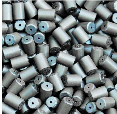
**Ядерное топливо** - это материал, который используется в ядерных реакторах в виде таблеток, располагающихся в тепловыделяющих элементах, объединенных в тепловыделяющие сборки. Ядерное топливо имеет самую высокую плотность энергии из всех возможных источников топлива. Одна топливная таблетка из диоксида урана массой 4,5 г выделяет энергию, эквивалентную сжиганию 350 м<sup>3</sup> природного газа или 350 кг нефти. Она вырабатывает свыше 1400 кВт/ч электроэнергии за 3 года. Этой
