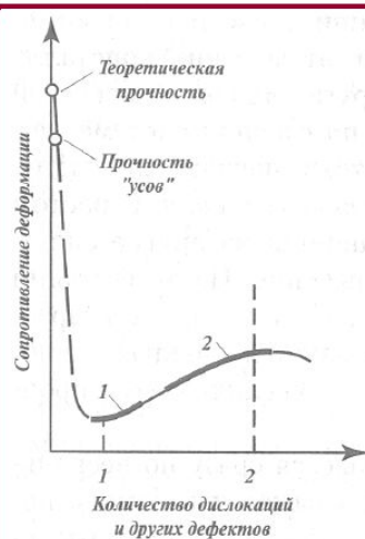
Рис. 7.5. Зависимость прочности от количества дислокаций и других дефектов кристаллической решетки (схема И.А. Одингга): 1 — чистые отожженные металлы; 2 — сплавы, упрочненные легированием, термической обработкой, пластической деформацией (наклеп) и т. п.
