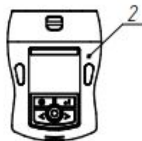
е) диффузионный отбор пробы (температура окружающего воздуха от минус 30 до плюс 45 °С, побудитель расхода (блок поперечный) поз.1 (7) - снят)
