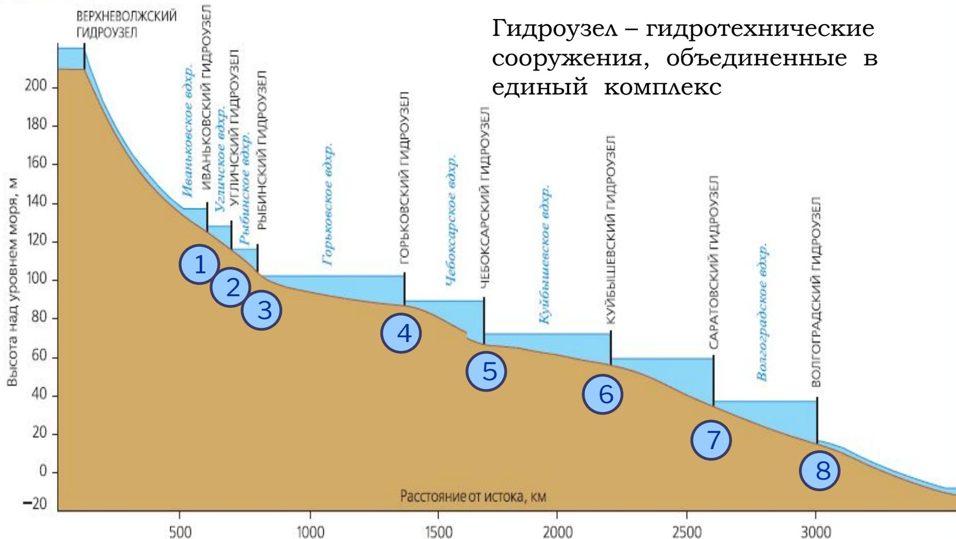
Гидроузел – гидротехнические сооружения, объединенные в единый комплекс
