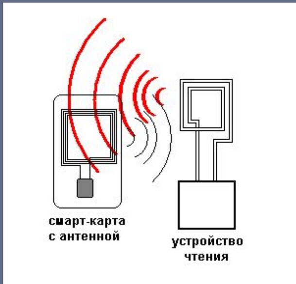
Для работы антенны карты такого типа могут иметь собственный элемент питания, а могут и работать за счет считывателя, в этом случае антенна карты выполняется в виде катушки индуктивности, которая начинает вырабатывать электрический ток находясь в сильном электромагнитном поле считывателя
