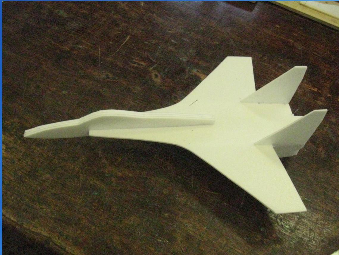
6. В носовую часть вклеиваем детали носового обтекателя в количестве 4 штук.
