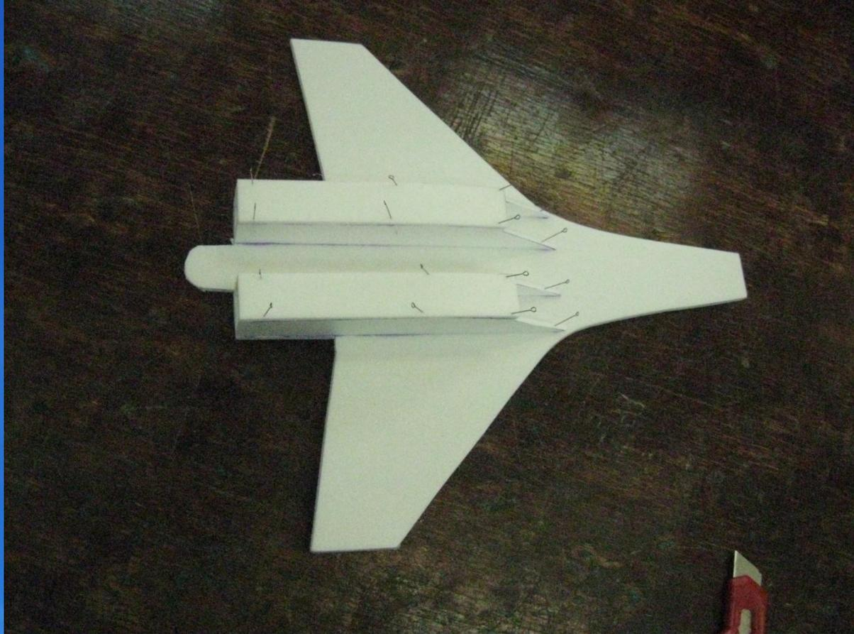
4. Закрываем их днищем двигательного отсека; фиксируем булавками.
