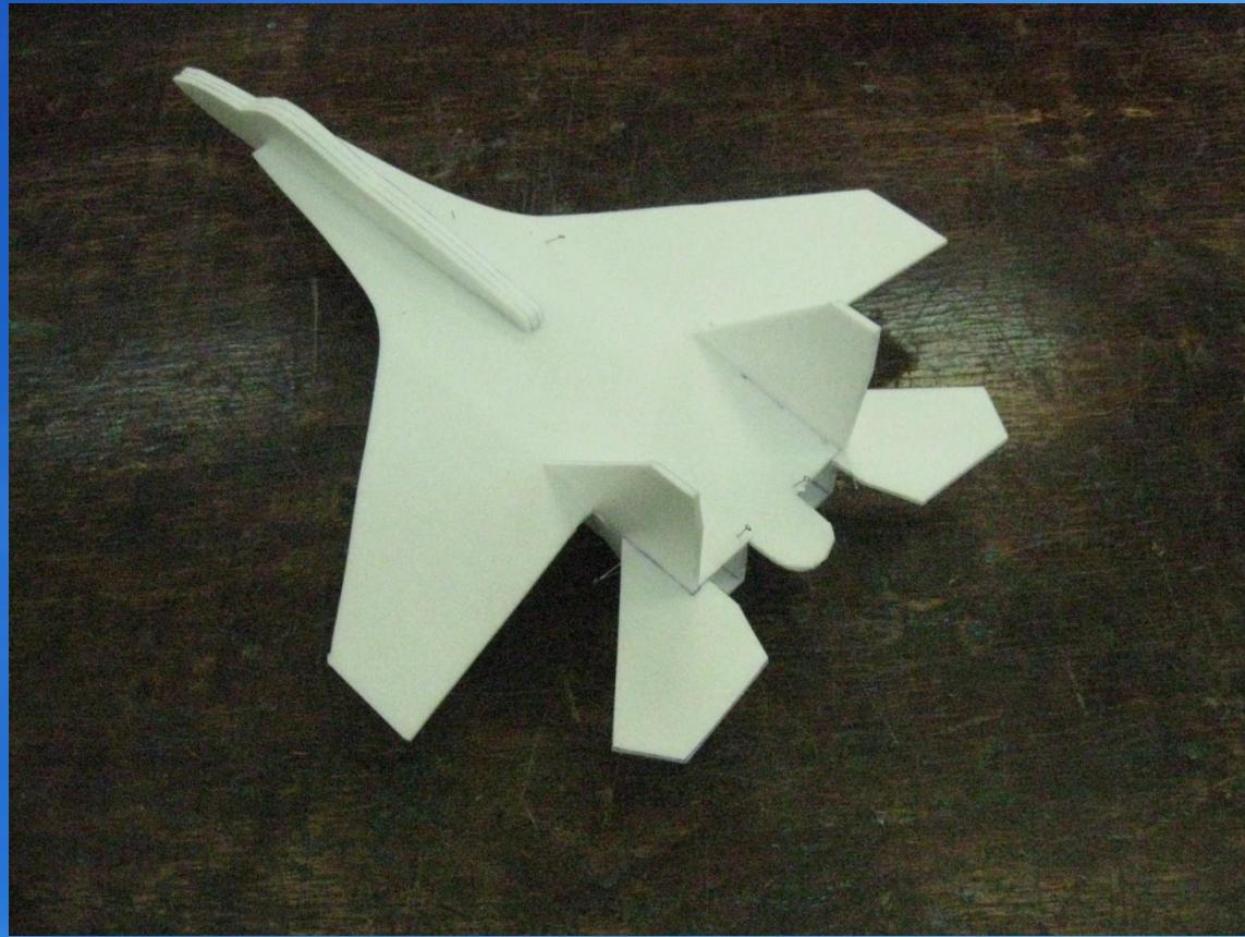
7. В хвостовой части фюзеляжа клеим стабилизатор.
