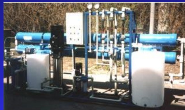
Установка обратного осмоса 6 м 3 /ч
