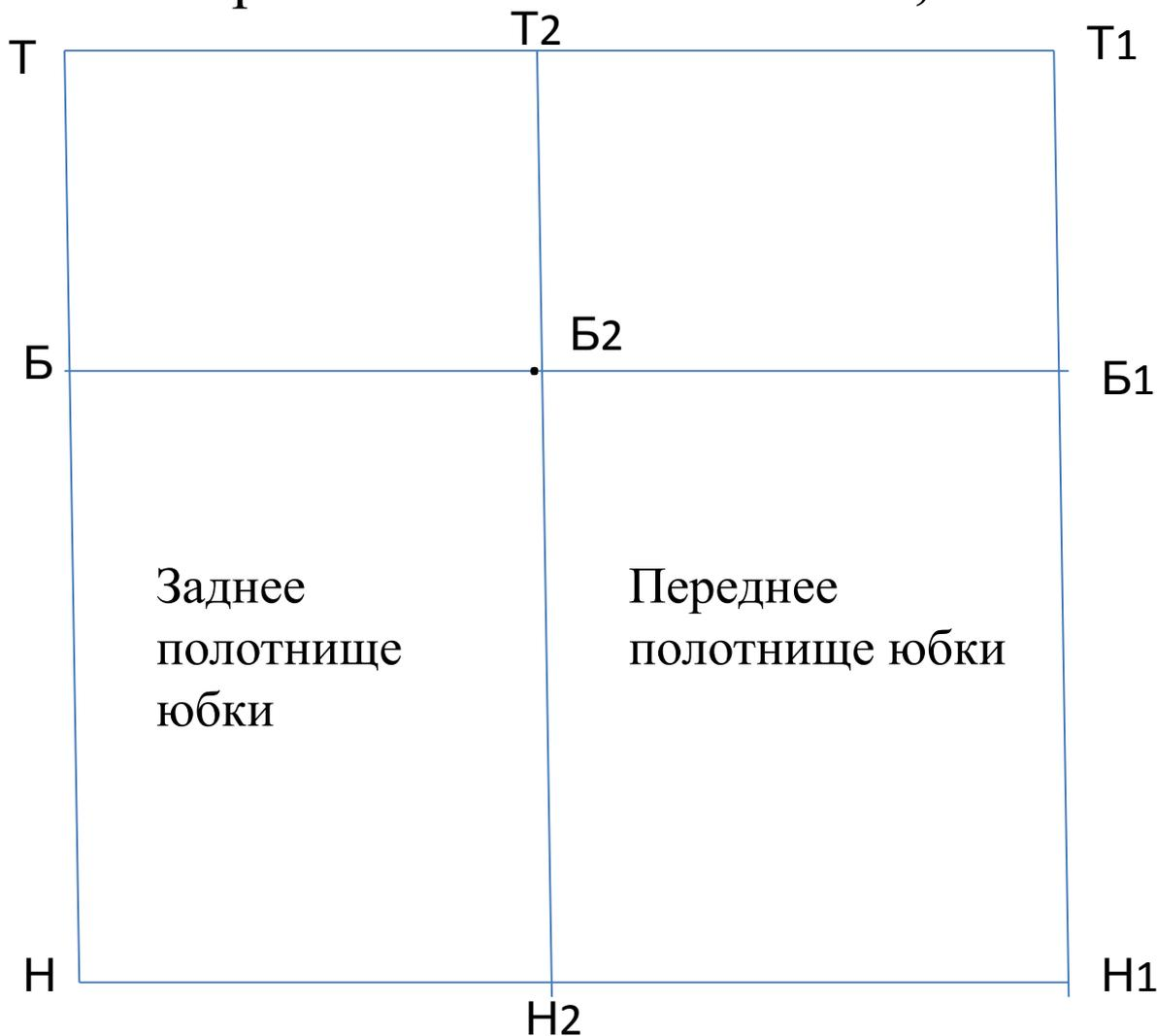
6. Отрезки **ББ2** и **Б2Б1** разделить пополам, полученные точки обозначить **Б3**(слева) и **Б4** (справа), затем из них провести вертикальные линии вверх. Точки пересечения обозначить **Т3**(слева) и **Т4**(справа).
