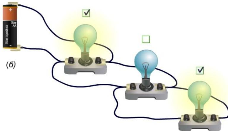
Параллельное – при перегорании
