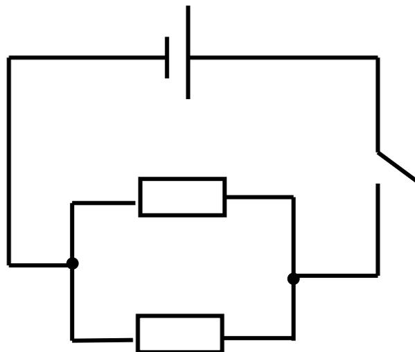
Параллельное соединение – это соединение, при котором начала всех проводников соединяют с одной точкой электрической цепи, а концы – с другой.
