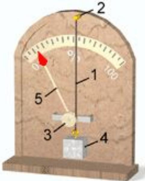
**Волосянной гигрометр**, в котором деталь, чувствительной к изменению влажности, служит обезжиренный человеческий волос [1]. Он закреплен в верхней части прибора [2], обернут вокруг ролика [3] и натянут при помощи специально подобранного груза [4]. К ролику прикреплена стрелка [5]. При увеличении относительной влажности воздуха волос удлиняется и вызывает вращение ролика вместе со стрелкой. Стрелка, передвигаясь по шкале, указывает значение влажности воздуха, выраженное в процентах.
