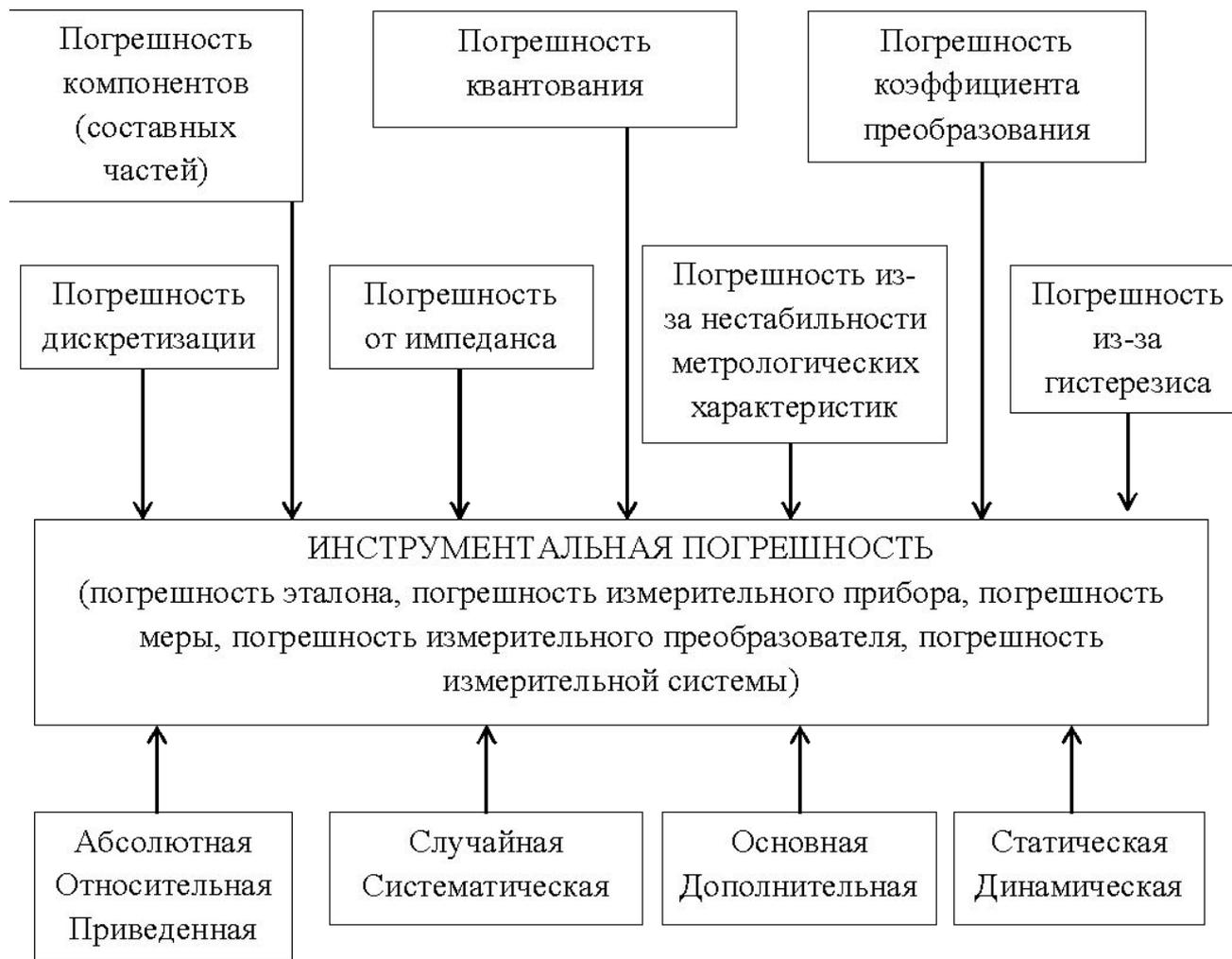
Рисунок 2 – Инструментальная погрешность и ее составляющие.
