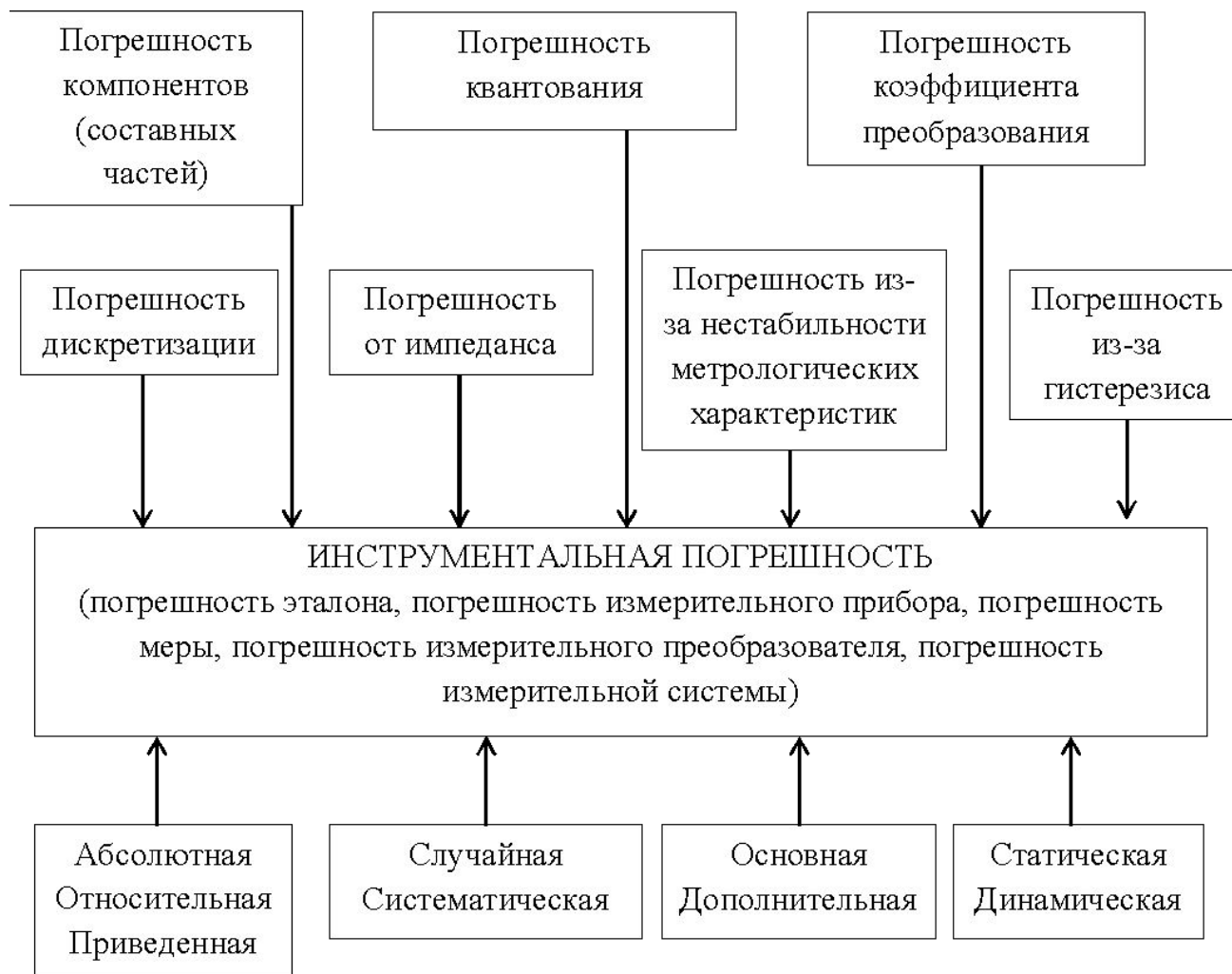
Рисунок 2 – Инструментальная погрешность и ее составляющие.
