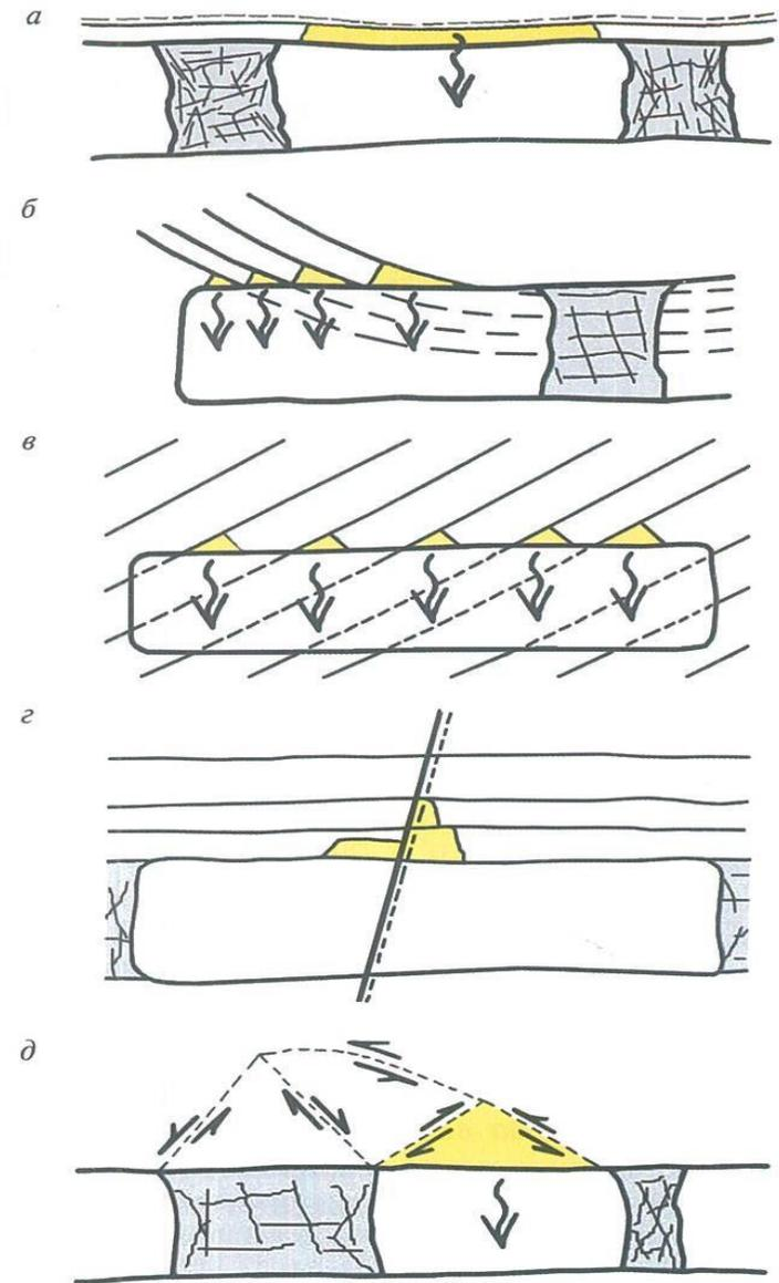
Рис. 5.6. Формы отслоений (I) и рациональные схемы установки анкерной крепи (II) при горизонтальном (а), вертикальном (б) и наклонном (в) залегании поверхностей ослабления массива
