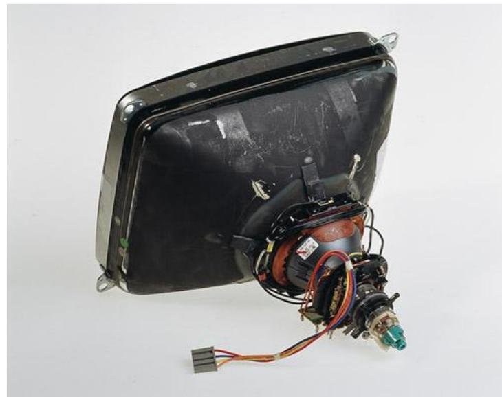
**Электронно – лучевая трубка** – электровакуумный прибор, в котором используется электронный пучок малого сечения, который может отклоняться в любом направлении, и, попадая на люминесцентный экран, создавать изображение.
