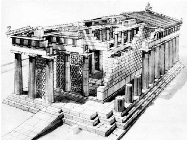
Продольный разрез Парфенона
