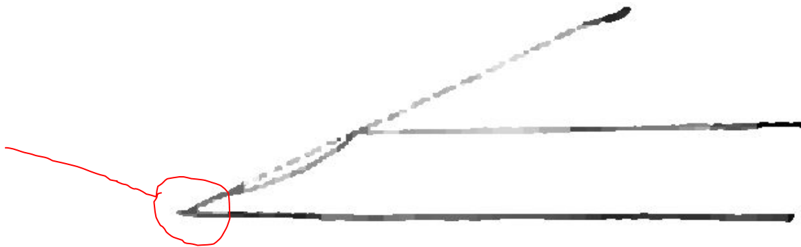
Правильно заточенная режущая кромка стамески
