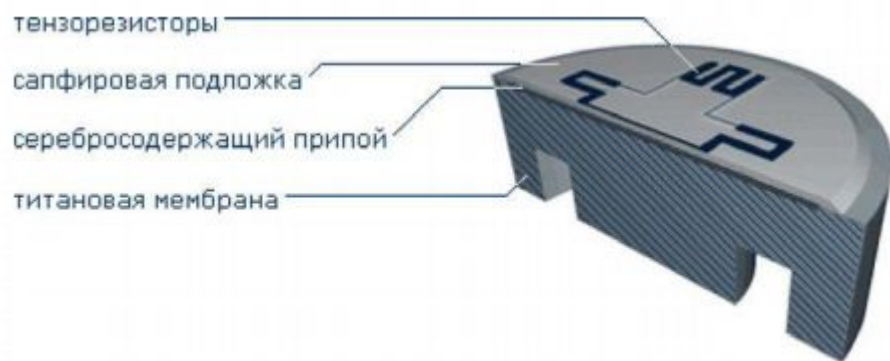
Рис.2. Упрощенный вид тензорезистивного чувствительного элемента
