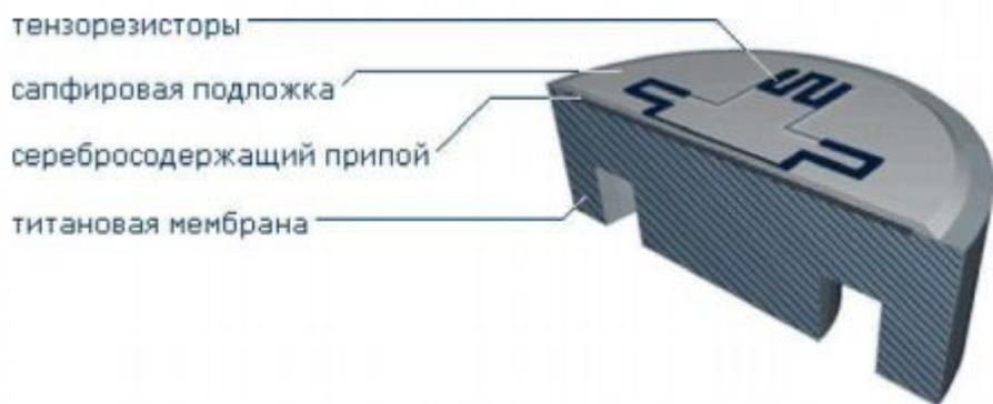
Рис.2. Упрощенный вид тензорезистивного чувствительного элемента
