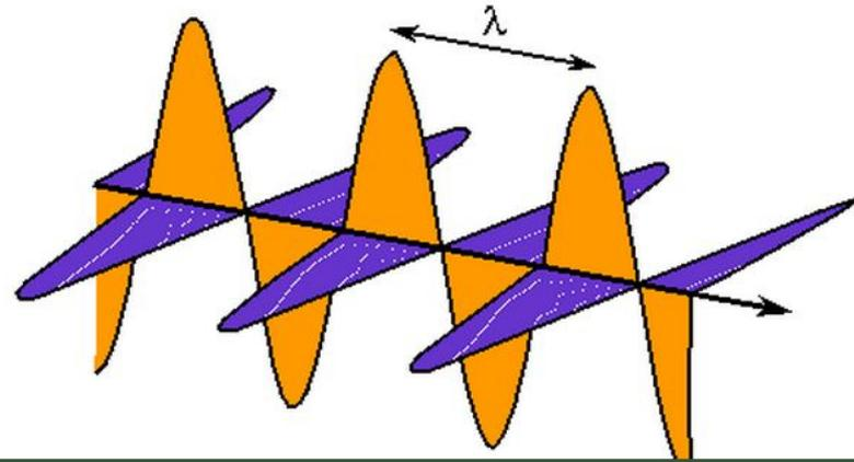
При переходе в другую среду  $\Rightarrow \begin{cases} v = \text{const} \\ T = \text{const} \end{cases}$
