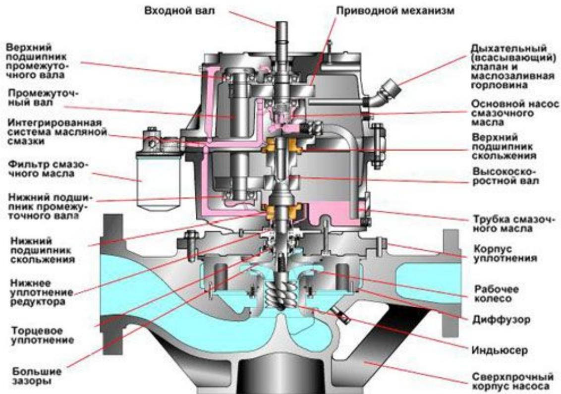
Насос с соединением с двигателем через мультипликатор
