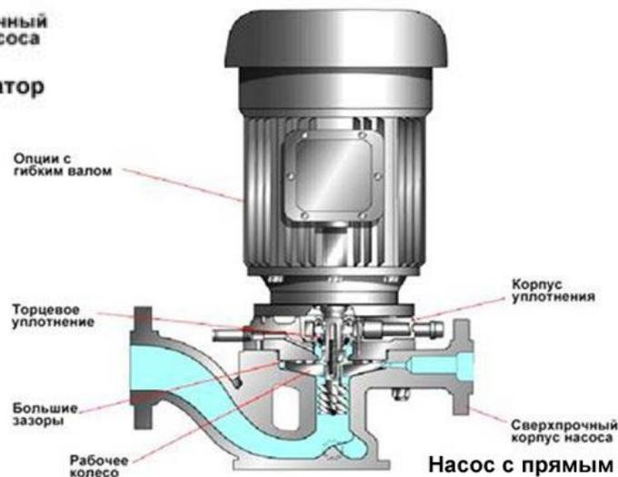
Насос с прямым соединением с двигателем
