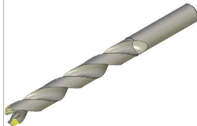
10) Готовая 3D-модель сборки сверла со сменными головками 12 мм
