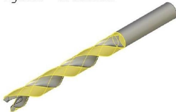
6) Формирование выхода стружечной канавки операцией "Спираль" и "Булева - вычитание"
