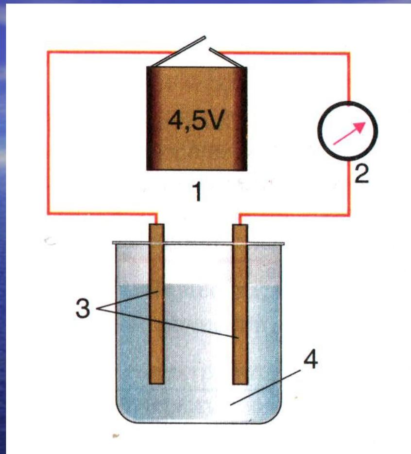
Схема прибора для определения электропроводности раствора:
