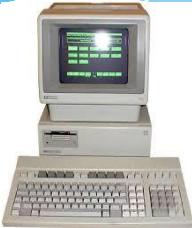
Самым первым компьютером - моноблоком можно считаться модель HP – 150, выпущенная компанией Hewlett-Packard в 1983 году. На тот момент моноблок имел девятидюймовую сенсорную панель, процессор Intel 8088 с частотой 8 МГц. У него не было рядом системного блока, последний был встроен в сам монитор. В передней части дисплея располагался CD-привод и встроенные инфракрасные датчики. Эти самые датчики позволяли управлять при помощи движений пальцами процессами, отображавшимися на мониторе.
