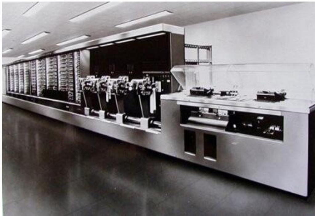
Первый компьютер «Марк I» был сконструирован в США. Его длина была 17 м, а высота 2.5 м. Его масса была около 5-ти тонн. Общая длина его проводов около 800 км!
