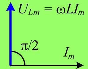
**Вывод** : из сравнения (4) и (7) следует, что падение напряжения на индуктивности опережает по фазе ток, текущий через катушку, на угол  $\phi = \pi/2$ , см. векторную диаграмму.
