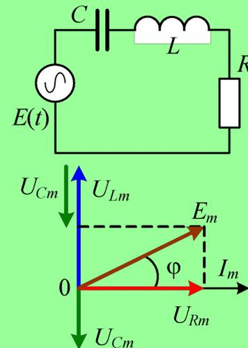
Из векторной диаграммы видно, что вектор амплитуды ЭДС  $E_m$  равен векторной сумме амплитуд падений напряжений на элементах цепи. Угол  $\phi$  определяет разность фаз между силой тока в цепи и напряжением ЭДС на зажимах цепи :
