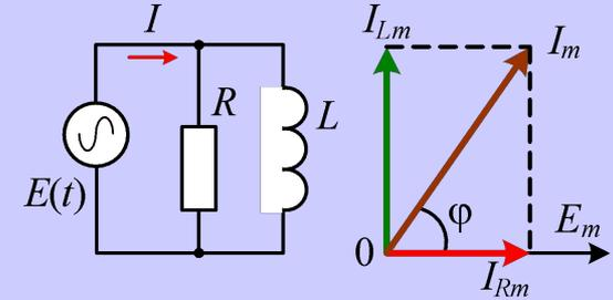
**A5. (B.14.27)** Активное сопротивление  $R$  и индуктивность  $L$  соединены параллельно и включены в цепь переменного тока напряжением  $E = 127 \text{ В}$  и частотой  $\nu = 50 \text{ Гц}$ . Найти сопротивление  $R$  и индуктивность  $L$ , если известно, что цепь поглощает мощность  $P = 404 \text{ Вт}$  и сдвиг фаз между напряжением и током  $\phi = 60^\circ$ .
