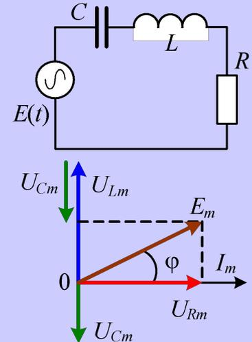
Из векторной диаграммы видно, что вектор амплитуды ЭДС  $E_m$  равен векторной сумме амплитуд напряжений на элементах цепи:
