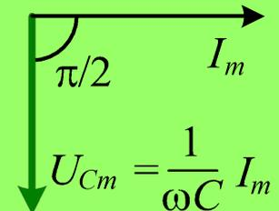
**Вывод** : из сравнения (9) и (12) следует, что ток, текущий через конденсатор, опережает по фазе падение напряжения на конденсаторе на угол  $\phi = \pi/2$ , см. векторную диаграмму.
