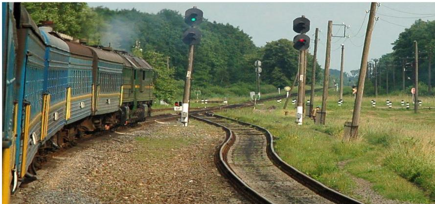
**Выходные светофоры** - устанавливаются для каждого отправочного пути впереди места, предназначенного для стоянки локомотива отправляющегося поезда
