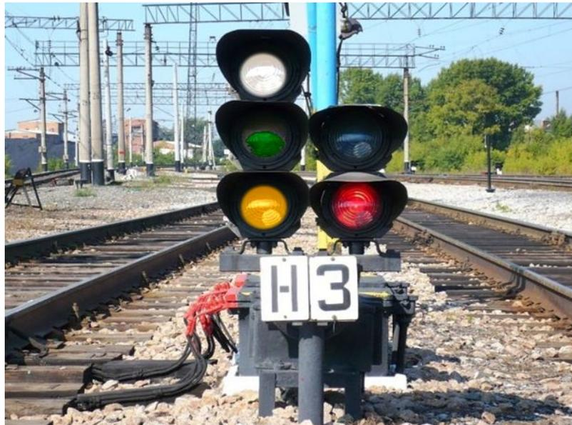
Погасшие сигнальные огни светофоров (кроме предупредительных на участках, не оборудованных автоматической блокировкой, заградительных и повторительных), непонятное их показание, а также непонятная подача сигналов другими сигнальными приборами требуют остановки поезда.
