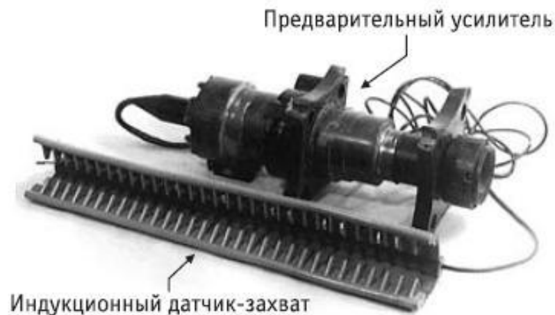
Индукционный датчик-захват и предварительный усилитель изделия «Камбала»
