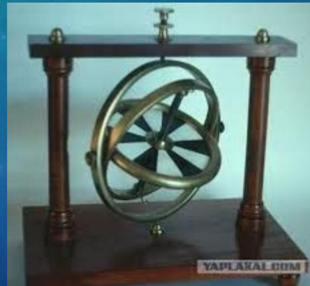
В наше время гироскопы широко применяются в науке и технике. В самолётах есть автопилоты, свернёт самолёт в сторону от курса, а волчок не хочет сворачивать, и подаёт сигнал – включает двигатель рулевого механизма. Заработал двигатель, повернул руль самолёта, и тот возвратился на правильный курс.
