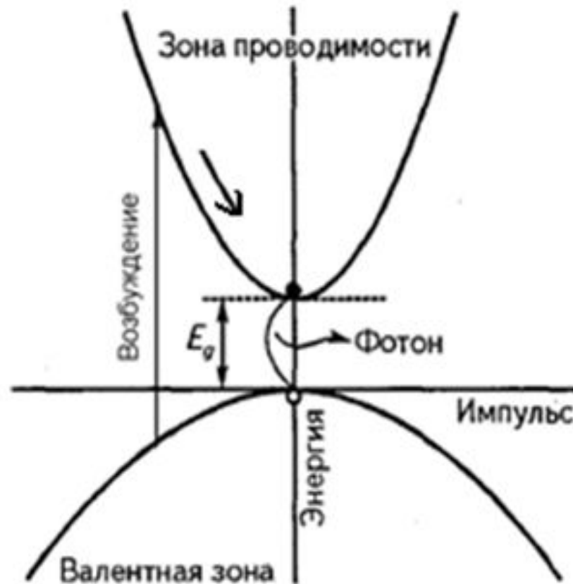
Схема механизма люминесценции
