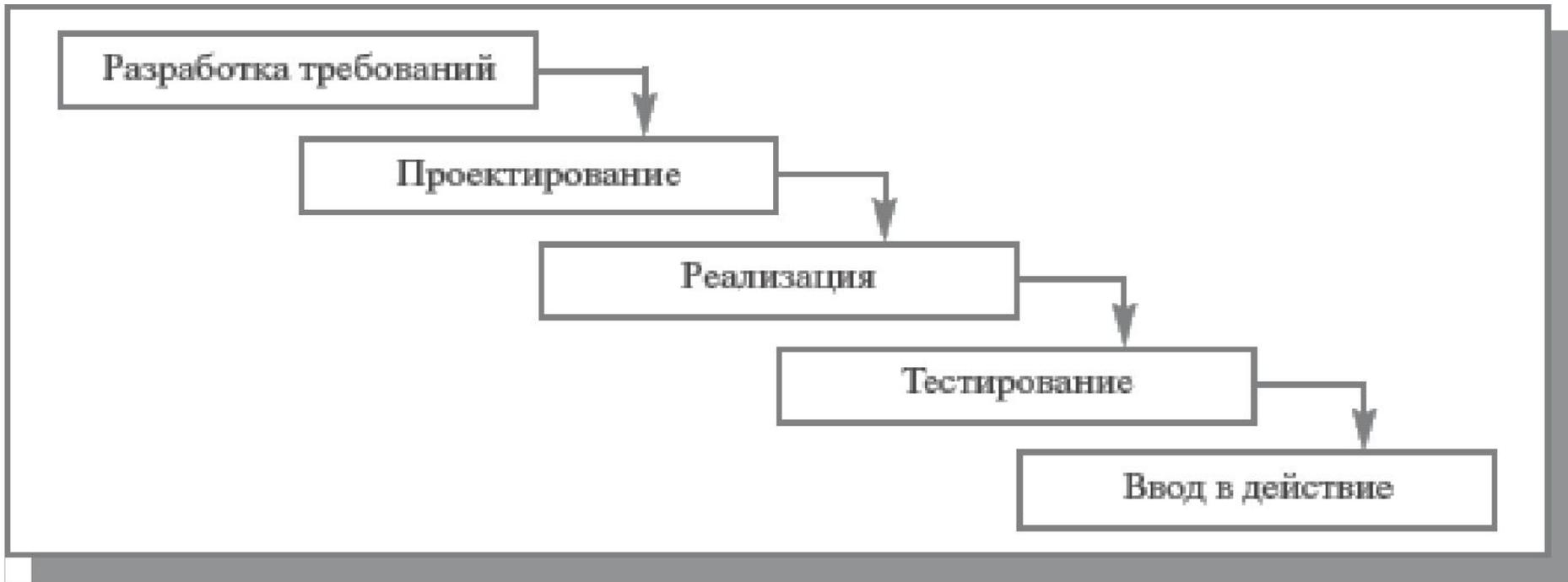
**Рис. 4.1.** Каскадная модель ЖЦ ПС
